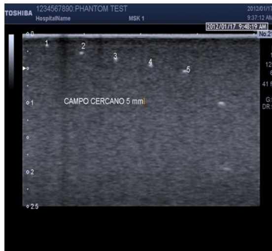
Figura 32 Procedimientos de prueba: grupo de campo cercano
