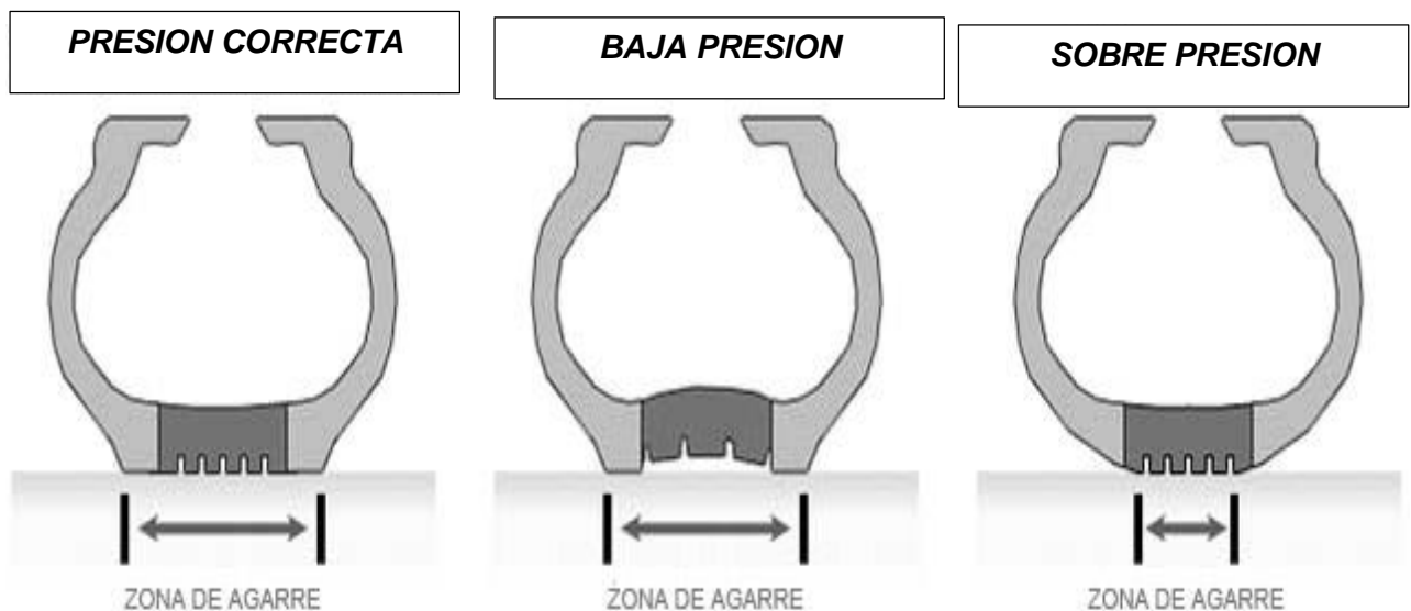
Ilustración 4 Presión de inflado http://www.bridgestone.com.mx/
