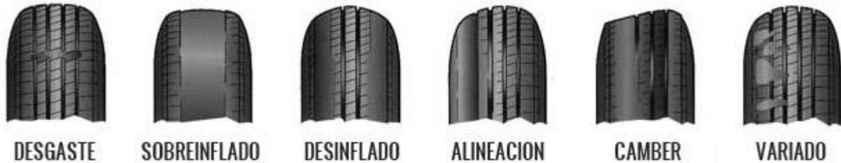
Ilustración 5 Señales de Desgaste http://www.virtuallantas.com/
