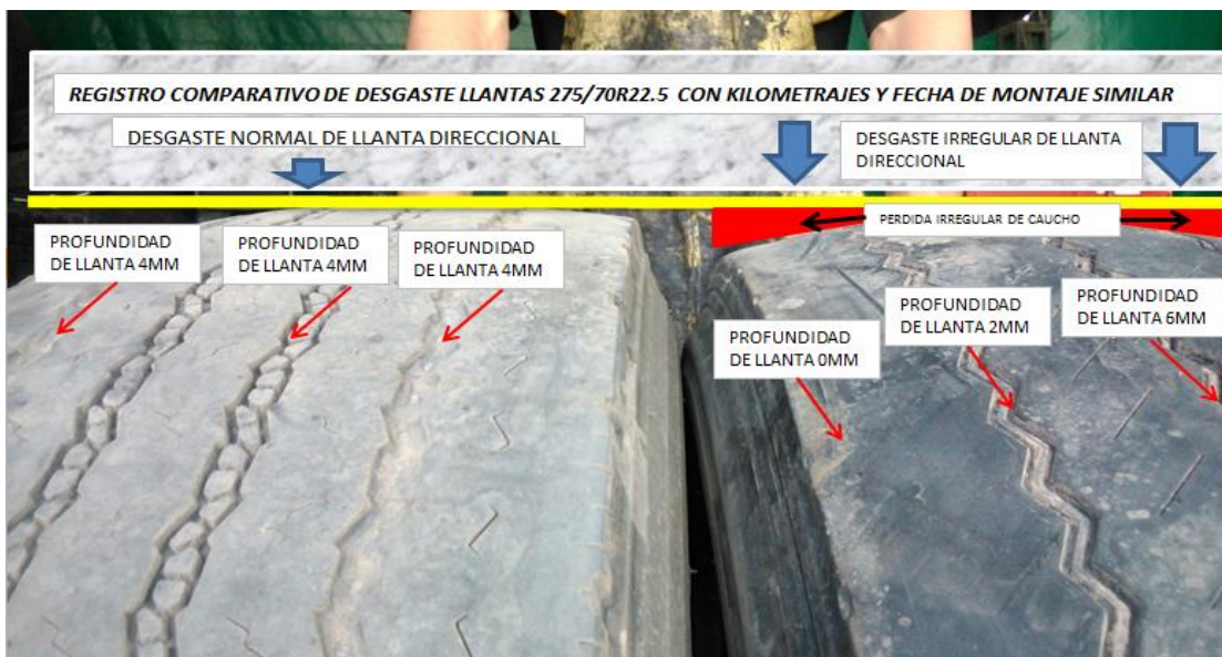
Grafico 1. Comparativo desgaste entre tipos de llanta, Imagen tomada durante el proceso de análisis.
