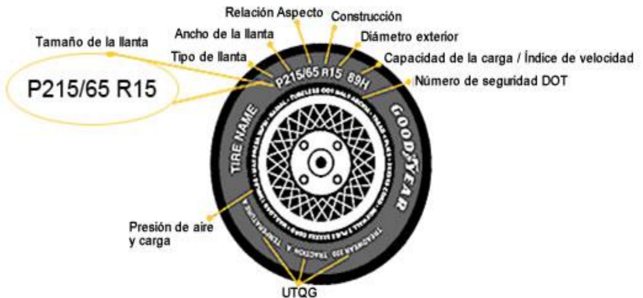
Ilustración 3 lectura del costado de una llanta, estudio sobre como leer una llanta de Goodyear http://www.goodyear.com.pe/
