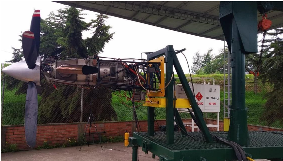
Figura 37 Turbina PT6A-61A montada sobre banco de pruebas, fuente Autor.
