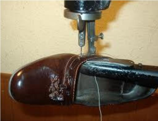
**Ilustración 3 Costura en máquina remendona**
