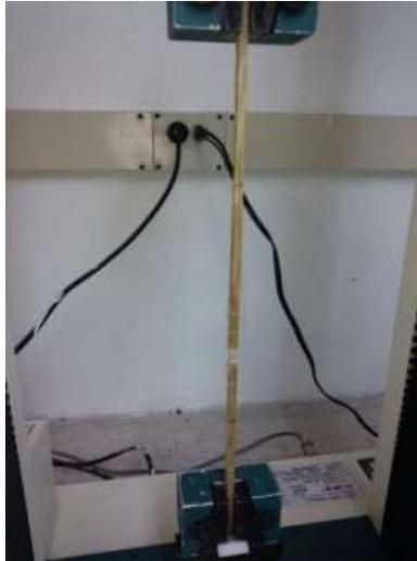
Figura 18 Ensayo de tensión de fique
