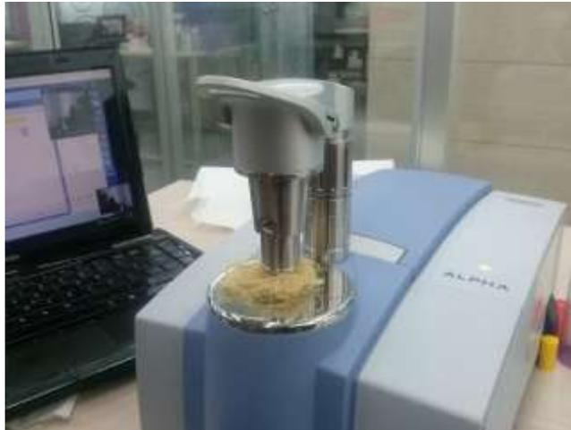
Figura 16 Ensayo de espectroscopia infrarroja en el fique
