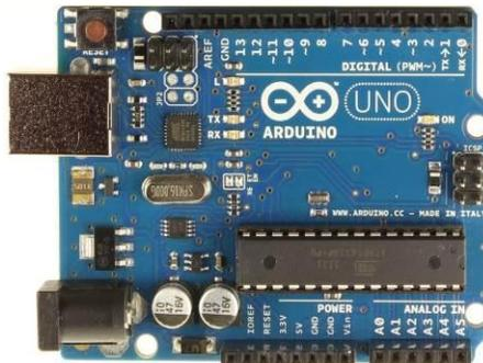
Figura 14. Aspecto físico de la tarjeta ARDUINO UNO R3 basada en el microcontrolador ATMEGA 328PU<sup>20</sup>
