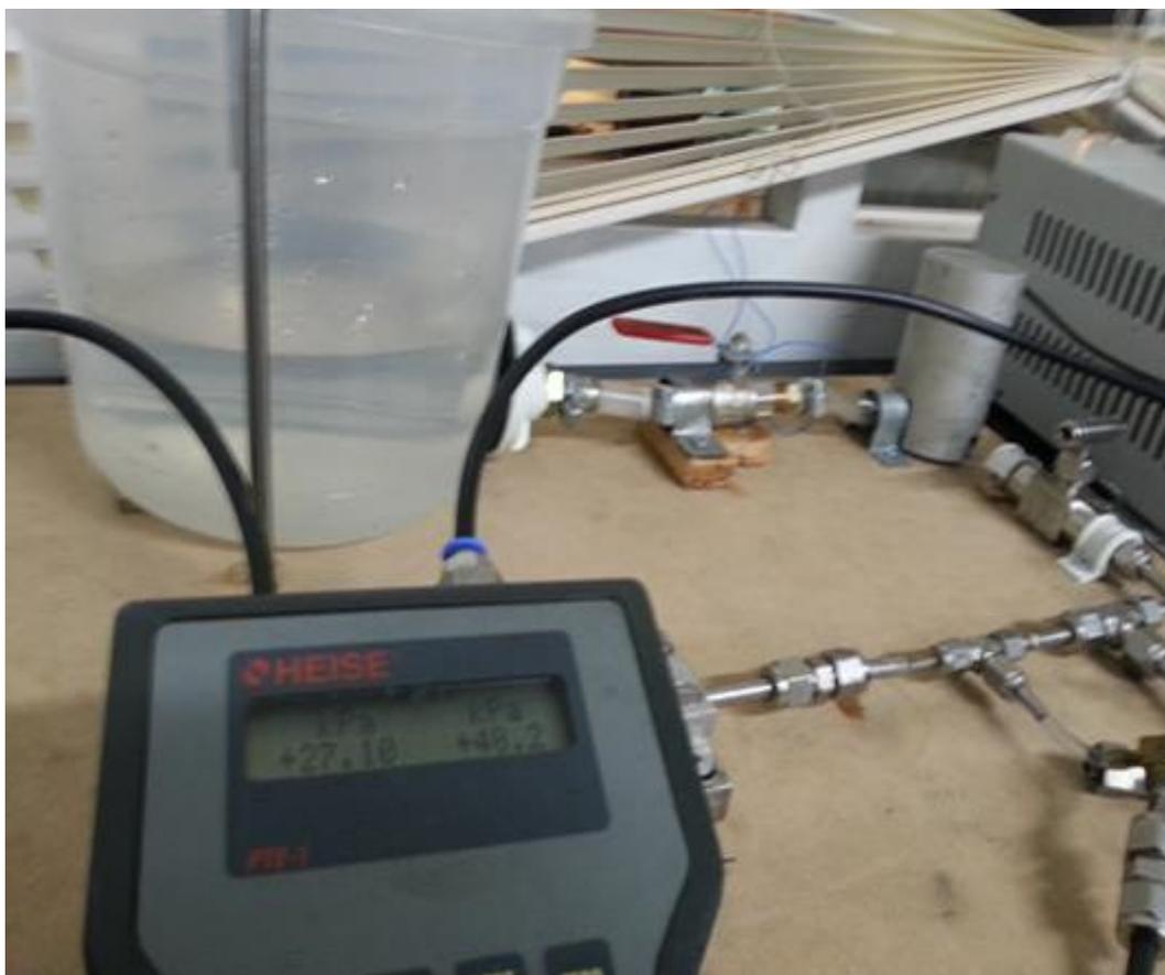
**Figura 4.8: Patrón de presión HEISE en prueba de presión ascendente y descendente**
