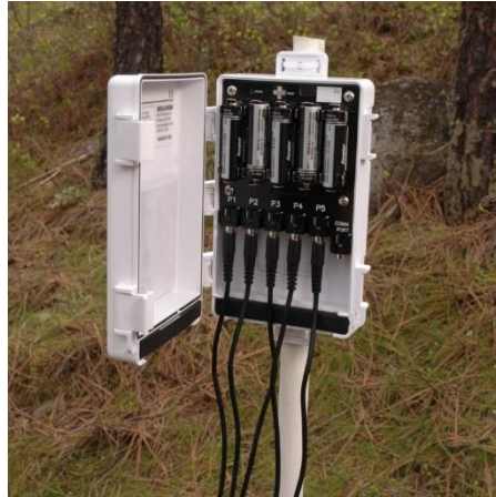
Fig 7. Nodo EM50 de la empresa DECAGON DEVICE. Este nodo tiene conectados 5 sensores en sus terminales y posee 5 pilas AA.
