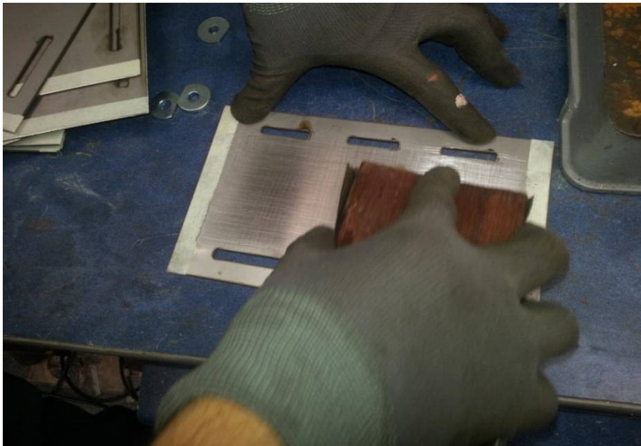
Ilustración 26: lamina de acero inoxidable en proceso de lijado
