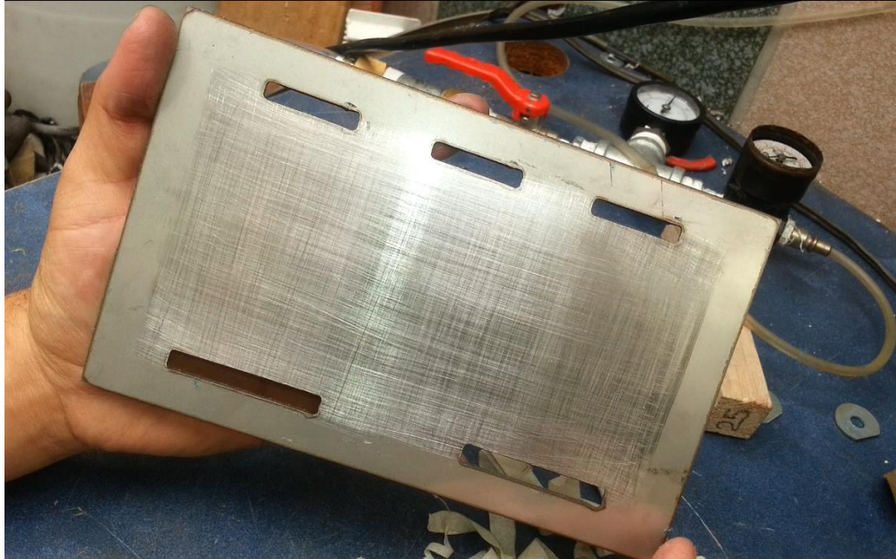
Ilustración 27: placa de acero inoxidable 304L despues del lijado
