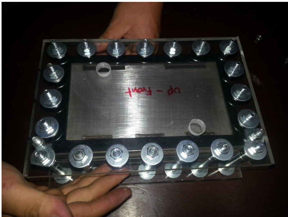
Ilustración 34: celda electrolítica ensamblada
