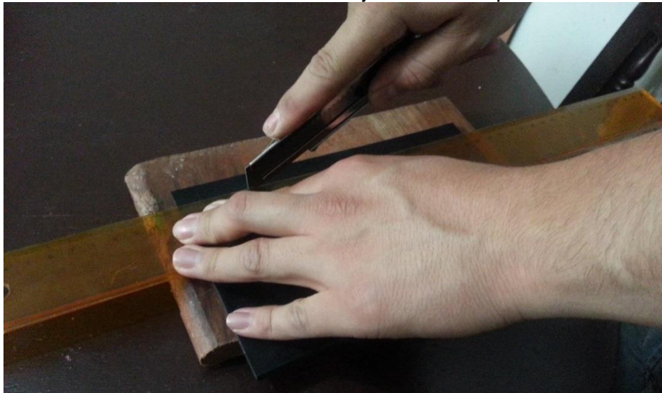
Ilustración 32: corte de juntas de neopreno
