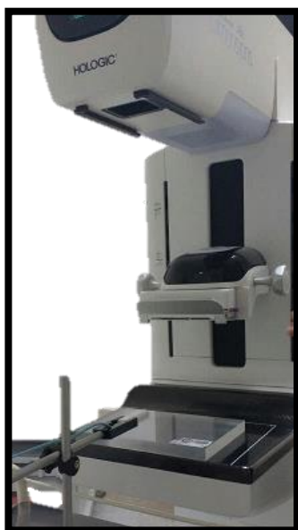
Figura 10. Montaje prueba de exactitud y repetibilidad de la tensión.
