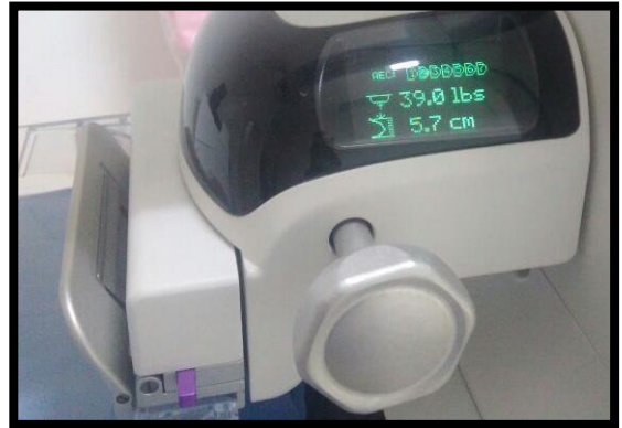
Figura 25. Indicador prueba fuerza de compresión modo automático
