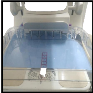
Figura 24. Báscula prueba fuerza de compresión modo automático
