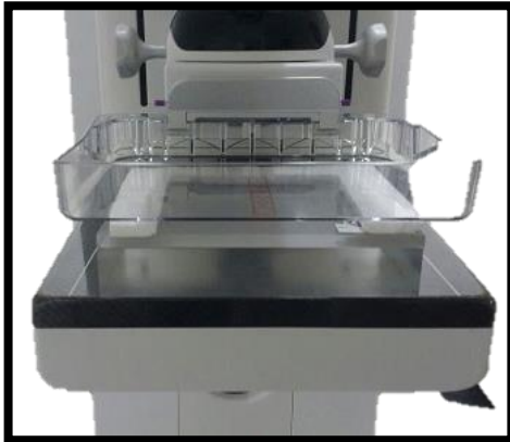
Figura 13. Montaje prueba de repetibilidad del CAE
