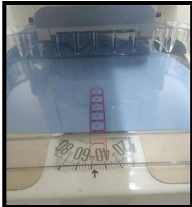
Figura 26. Báscula prueba fuerza de compresión modo manual
