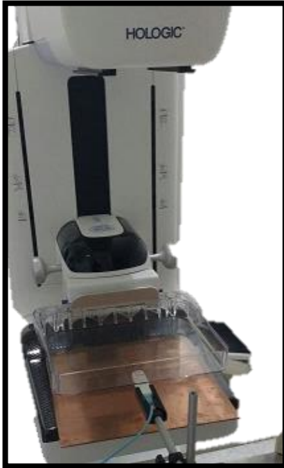
Figura 11. Montaje prueba de filtración de la capa hemireductora.
