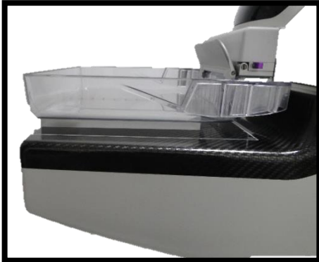
Figura 28. Montaje de prueba calidad de imagen.
