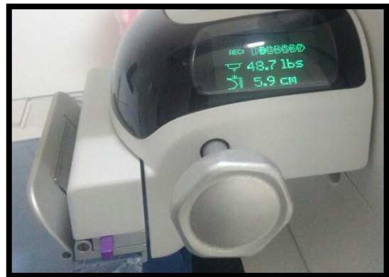
Figura 27. Indicador prueba fuerza de compresión modo manual
