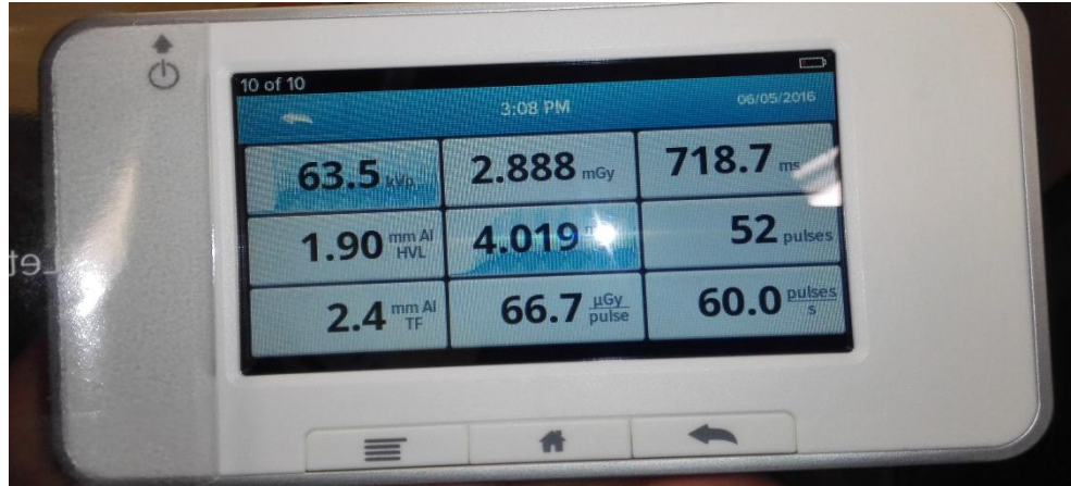
Figura 11. Datos Obtenidos a través del Analizador de rayos X marca Ray-safe, modelo X2
