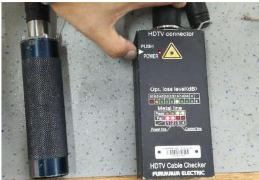
Imagen 19 medición de niveles de potencia con FMEC-LS-LS-1 (Autores, 2019)
