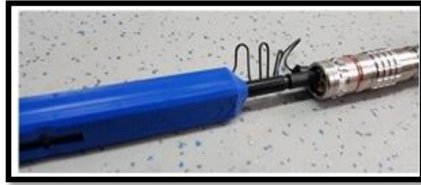
Imagen 27 limpieza del conector de fibra con oneclick. (Autores, 2019)
