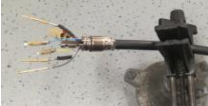
Imagen 14 guía alineadora conector hembra y macho. (Autores, 2019)
