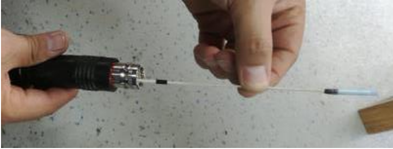
Imagen 29 limpieza con copo limpiador. (Autores, 2019)
