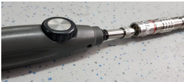
Imagen 21 inspección de conector macho con cámara portátil. (Autores, 2019)
