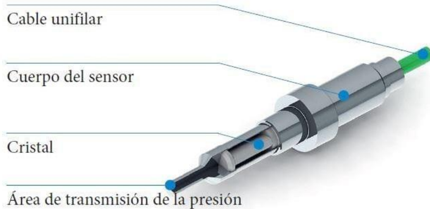
Figura 5: Sensor para la medida directa de la presión.
