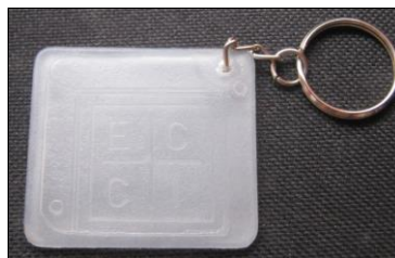
Figura 9–Llavero de Universidad ECCI inyectado. Fuente: Autor
