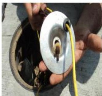
En esta imagen, los elementos de calibración para profundidad de las sondas muy deteriorados y se arriesga perder la sonda al reventarse los elementos por oxidación.
