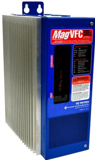
Conocido comúnmente con variador de frecuencia para bombas sumergibles superiores a 2hp, lo que realiza este equipo es suministrar la cantidad de corriente necesaria para el giro del motor o de la turbina para cierto suministro de combustible.
