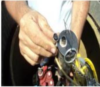
En esta imagen, La sonda al momento de la desconexión y retiro del tanque, la consola emitió la señal de no se detecto sonda.
