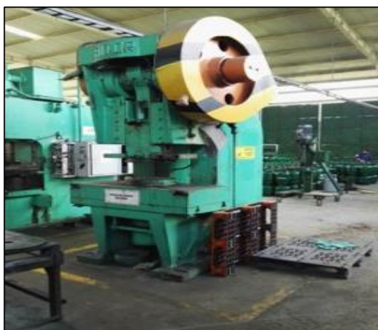
Figura 6. Maquina prensa sin demarcación
