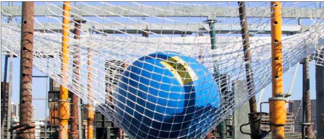
Imagen 15 redes de protección con nudo (imagen tomada de http://unmundoderedes.com/ )
