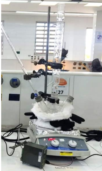
Figura 14: Montaje síntesis de nanopartículas por medio del método de coprecipitación en metanol. Adaptada de: Elaboración propia.
