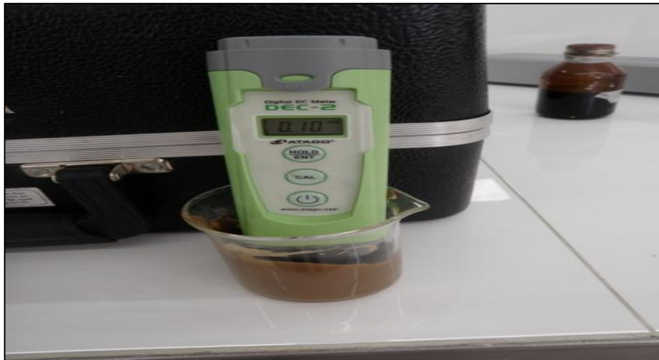
Imagen 3 Identificación del potenciómetro en la pasta de saturación
