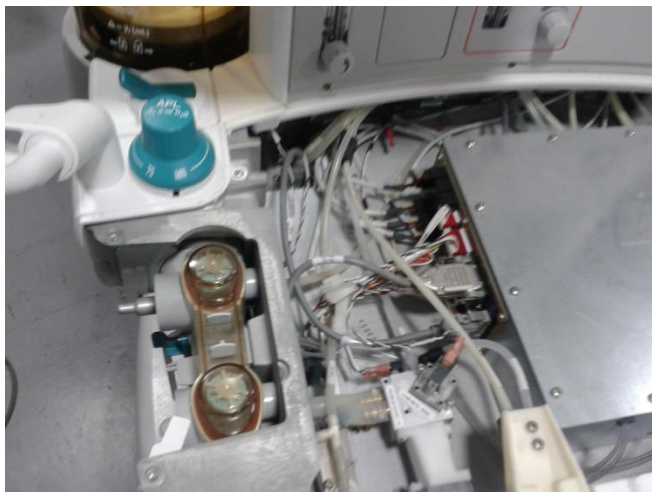
Ilustración 24 Válvula APL y fase circuital del paciente (Practico)
