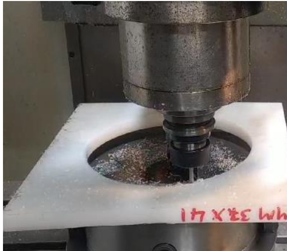
Figura 35. Redondeo del contorno interior con una fresa esférica.
