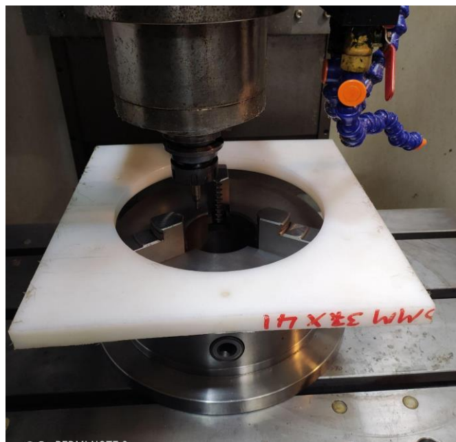
Figura 18. Sujeción para realizar los mecanizados de la segunda cara de ambas piezas.
