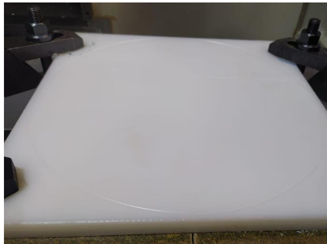
Figura 33. Ejecución del código referente al contorno del disco.
