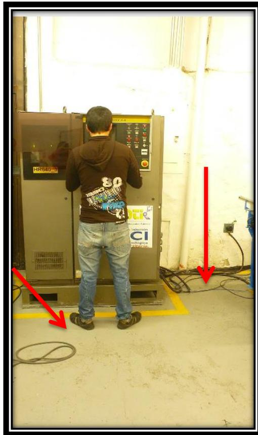
Fotografía.9. no uso de EPI necesarios y cables no canalizados,
