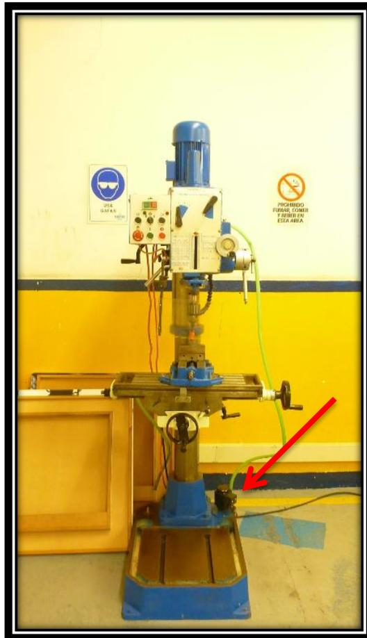
Fotografía.5.area de máquina no delimitada y cables no canalizados
