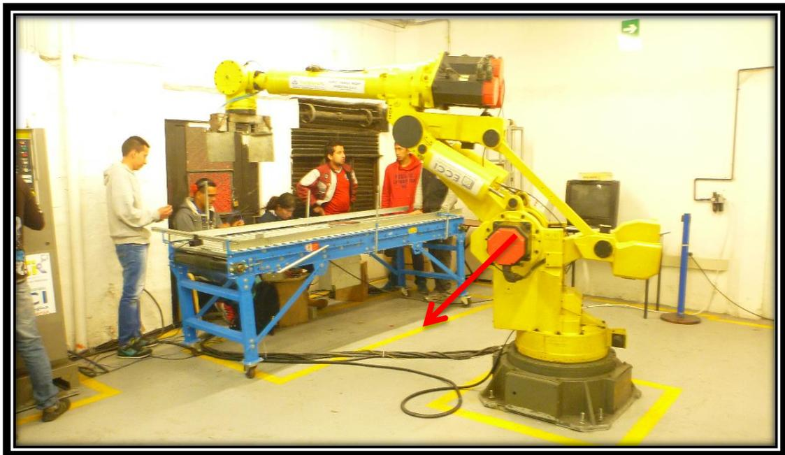
Fotografía.8. cables no canalizados
