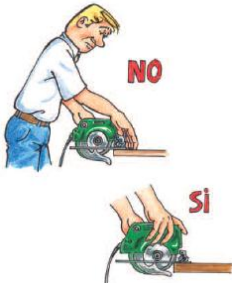
Figura 17. Agarre Correcto de Herramientas Manuales y de Potencia. Fuente: Manual de seguridad y salud en carpinterías de madera de FREMAP, 2012, pag.11
