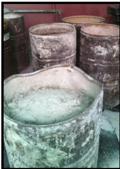
Foto 7: Cuarto de tierras y lodos – Tierras provenientes del proceso del desgomado de soya y blanqueo
