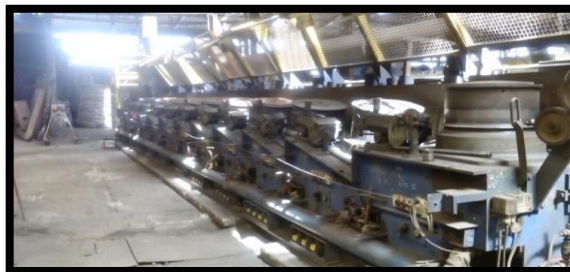
Foto 2. Maquina trefiladora Fuente: autor.
