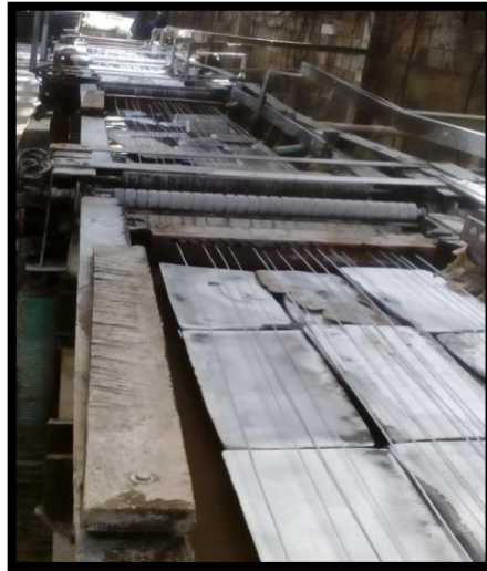
Foto 11. Cubas de decapado 2 sin agua Fuente: Autor.
