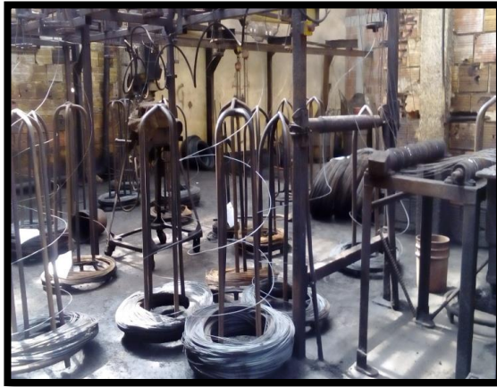
Foto 5. Devanadores línea de galvanizado
