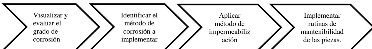
**Nota:** Con base en la información de las encuestas realizadas, se identificó que las partes que tienen mayor afectación son el chasis y la carrocería de los vehículos; para este caso el mejor método anticorrosivo a implementar es por medio de un recubrimiento no metálico (pintura anticorrosiva) y para aumentar su durabilidad se deben implementar actividades de limpieza periódicas.
