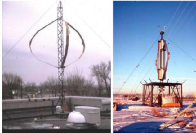
**Figura 3-3:** Darrieus Aerogenerador de Eje Vertical
