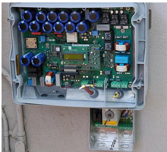
Figura 4-9: Inversor fotovoltaico
