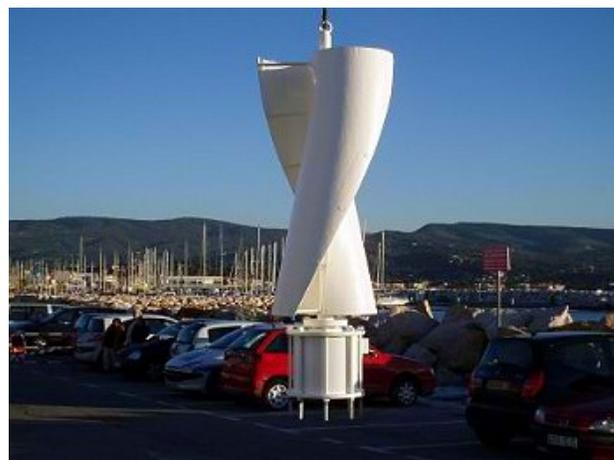
**Figura 3-6:** Turbina eje Vertical tipo Windside
