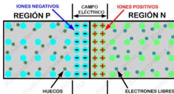
**Figura 4-5:** Unión de las capas semiconductoras en una celda solar fotovoltaica [33]
