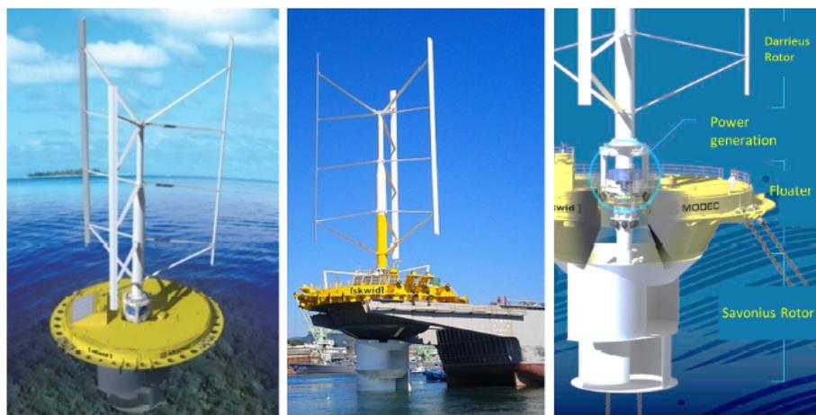
**Figura 3-4:** Turbina eje Vertical de Savonius
