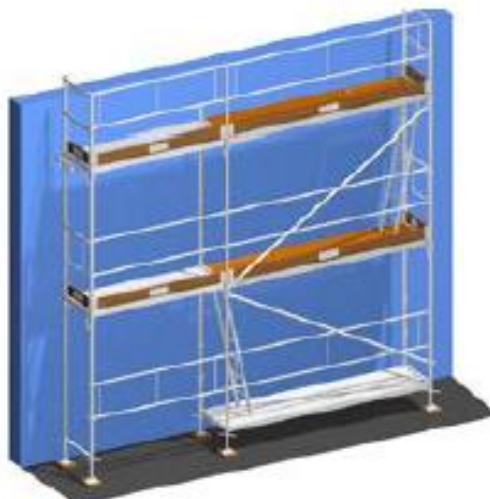
Imagen 11 Protecciones perimetrales para andamios multidireccionales tipo roseta. 20
