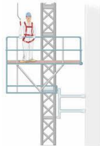
Imagen 5 Andamio tipo volado 5
