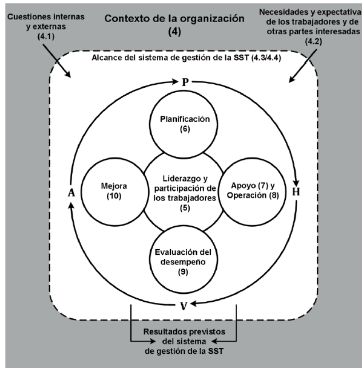
Ilustración 16: Ciclo Planificar-Hacer-Verificar-Actuar. El enfoque del sistema de gestión de la SST aplicado en este documento se basa en el concepto de (PHVA).
