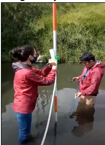
Imagen 13 y 14. Toma de caudal con correntómetro
