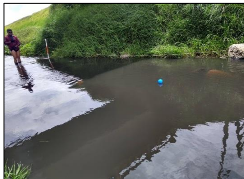
Imagen 15 y 16. Toma de caudal con flotador
