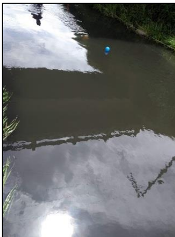
Imagen 15 y 16. Toma de caudal con flotador
