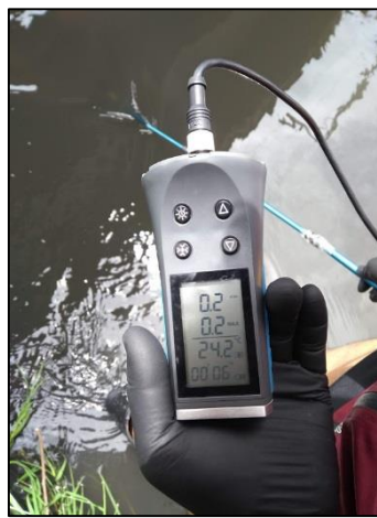
Imagen 13 y 14. Toma de caudal con correntómetro
