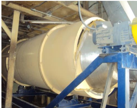
Figura 4.18 Enfriador Soya Extruida
