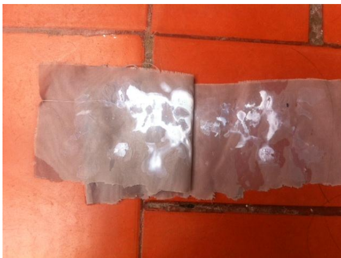
Figura 4. Resultado de adherencia de tela después de lavado con agua fría
