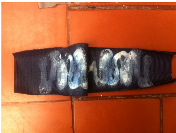
Figura 5. Resultado de adherencia de tela después de lavado con agua caliente
