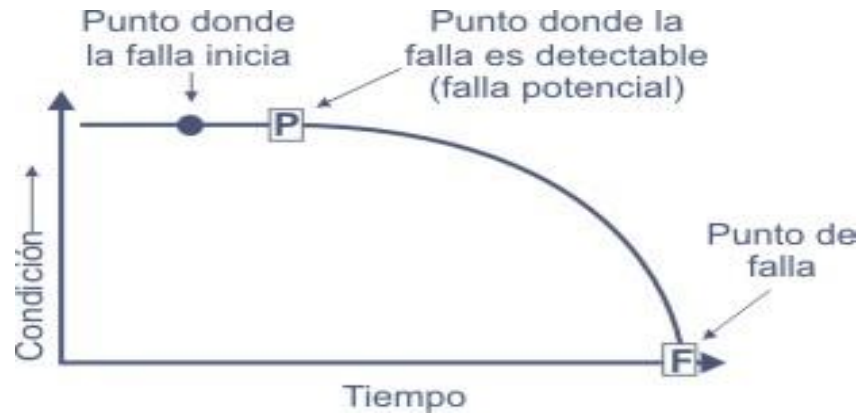
Figura 5.3. Inicio de Falla – Final de la Falla P-F.
