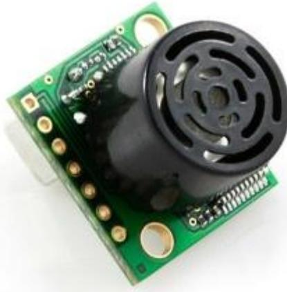
**Figura 4. Imagen de un sensor ultrasónico XL- Maxonar EZ4 [8]**
