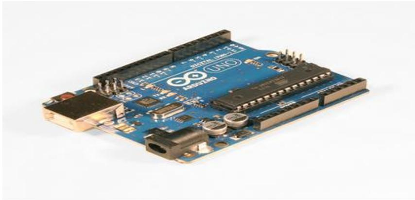
**Figura 4. Imagen de una tarjeta arduino Uno- R3 [13]**
