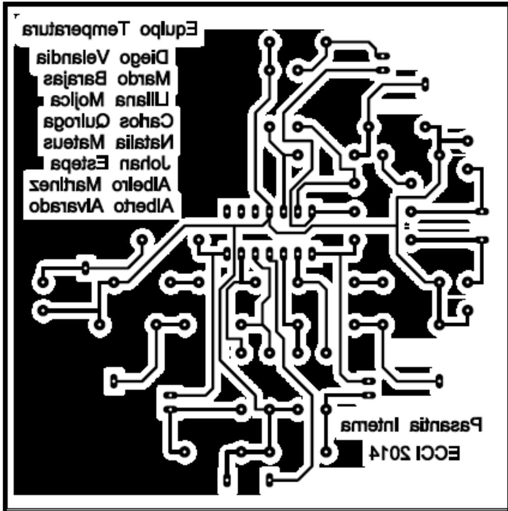
Figura A-2: Impreso para tarjeta conversor de corriente a voltaje
