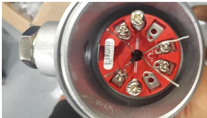
*Figura 3 – Conexión Sensor al transmisor*
