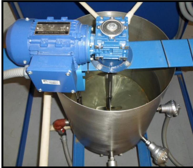
**Figura 9:** Moto agitador y resistencia Tanque 3.
