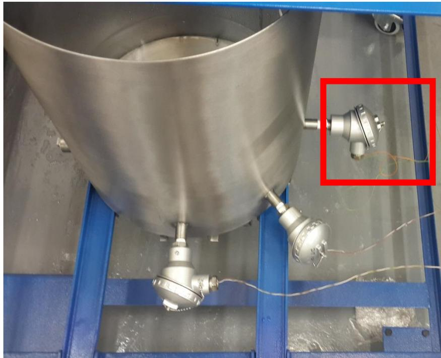
*Figura 2 – Ubicación Sensor en el Tanque*
