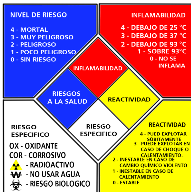
Imagen 85: Rombo de seguridad NFPA con todas las condiciones establecidas.
