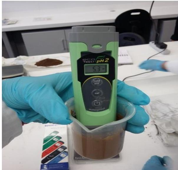
Imagen N° 13. Mezcla para determinar composiciones del suelo y Figura 16 pH midiendo la acides del suelo.
