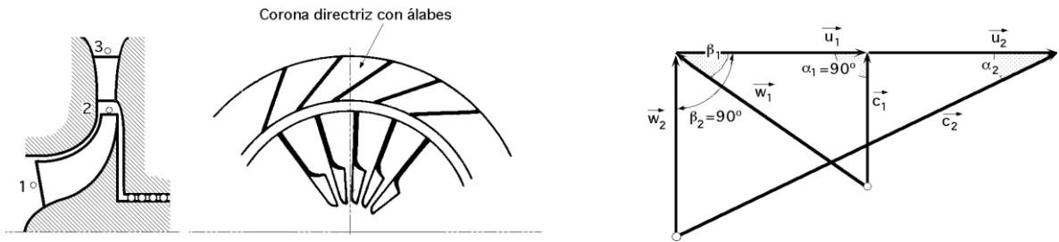
FIGURA 15.- Turbocompresor radial con álabes del rodete curvados a la entrada y salida radial de la corriente relativa (Triángulo de entrada, \alpha_1 = 90^\circ y triángulo de salida, \beta_2 = 90^\circ ; este tipo de triángulos es frecuente en los TC.
