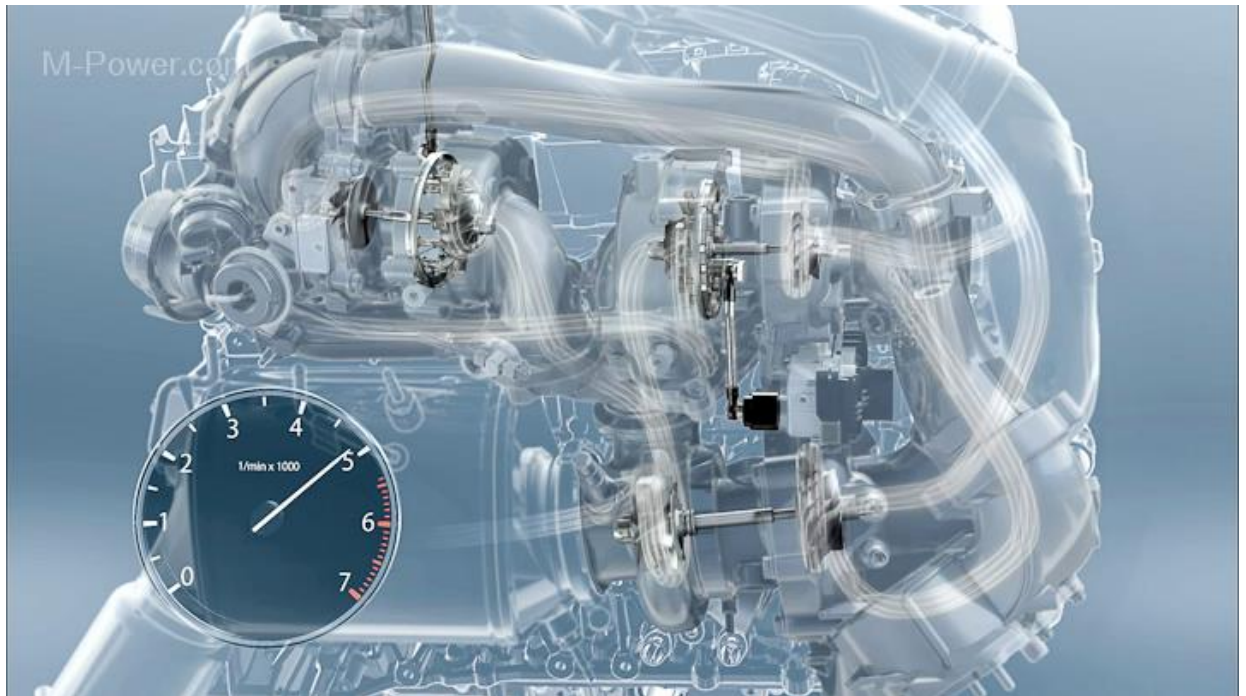
FIGURA 25. Grafica 3D del funcionamiento del triturbo www.elconfidencial.com
