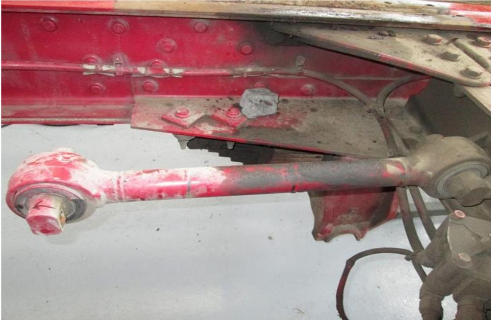
**FIGURA 43. UNIÓN BRAZO DE CONTROL LONGITUDINAL. DE LOS AUTORES**
