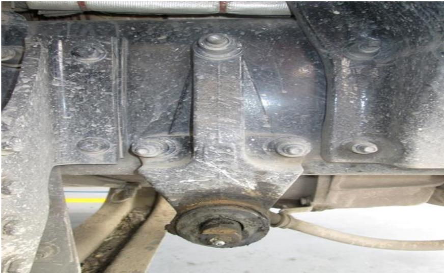
**FIGURA 32. UNIÓN SUSPENSIÓN DELANTERA. DE LOS AUTORES**
