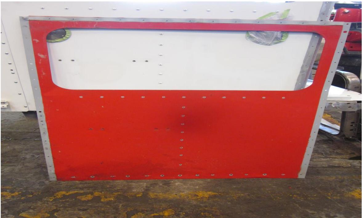
**FIGURA 15. UNIÓN DEL PANEL TRASERO. DE LOS AUTORES**
