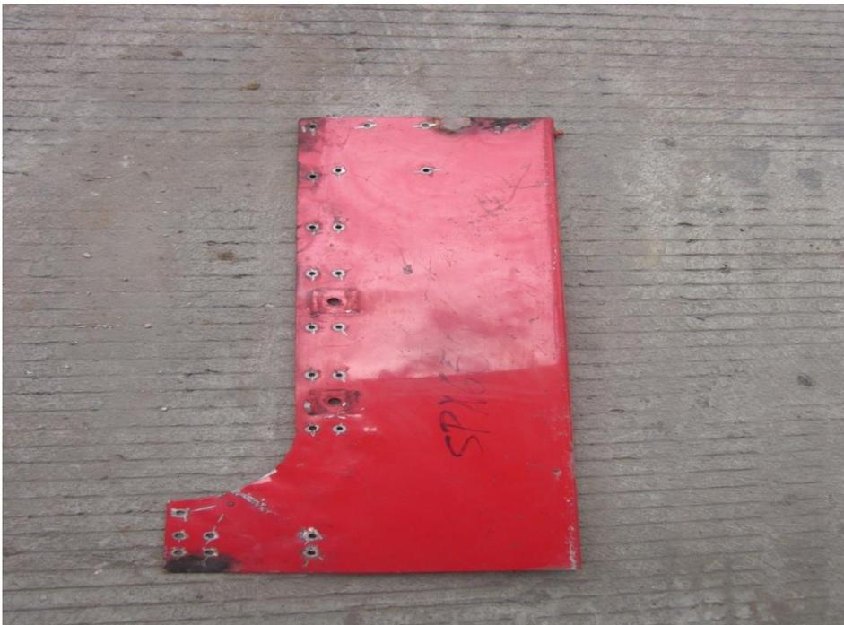
**FIGURA 20. UNION PARAL DELANTERO SECCION INFERIOR. DE LOS AUTORES**
