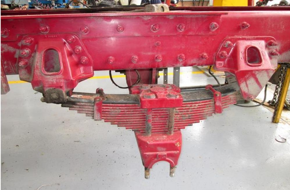
**FIGURA 41. UNIÓN SUSPENSIÓN TRASERA. DE LOS AUTORES**
