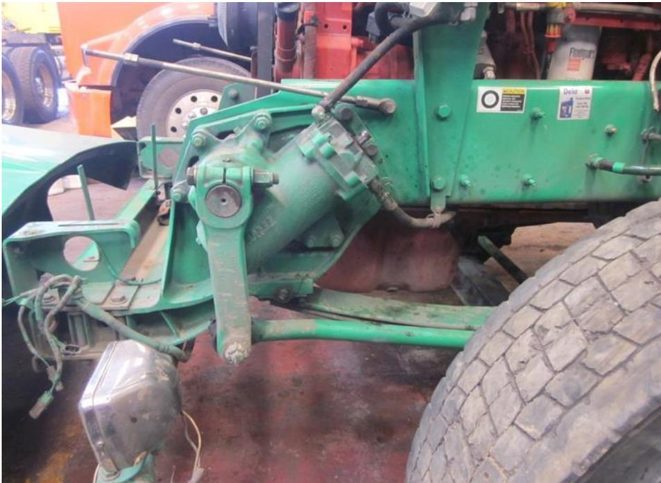
**FIGURA 38. UNIÓN CAJA DE DIRECCION. DE LOS AUTORES**
