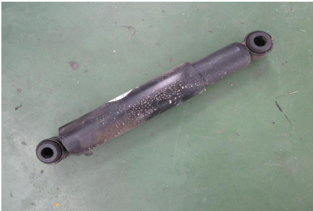
**FIGURA 40. UNIÓN DEL AMORTIGUADOR TRASERO. DE LOS AUTORES**
