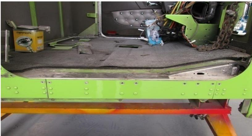
**FIGURA 14. UNIÓN DEL ESTRIBO. DE LOS AUTORES**
