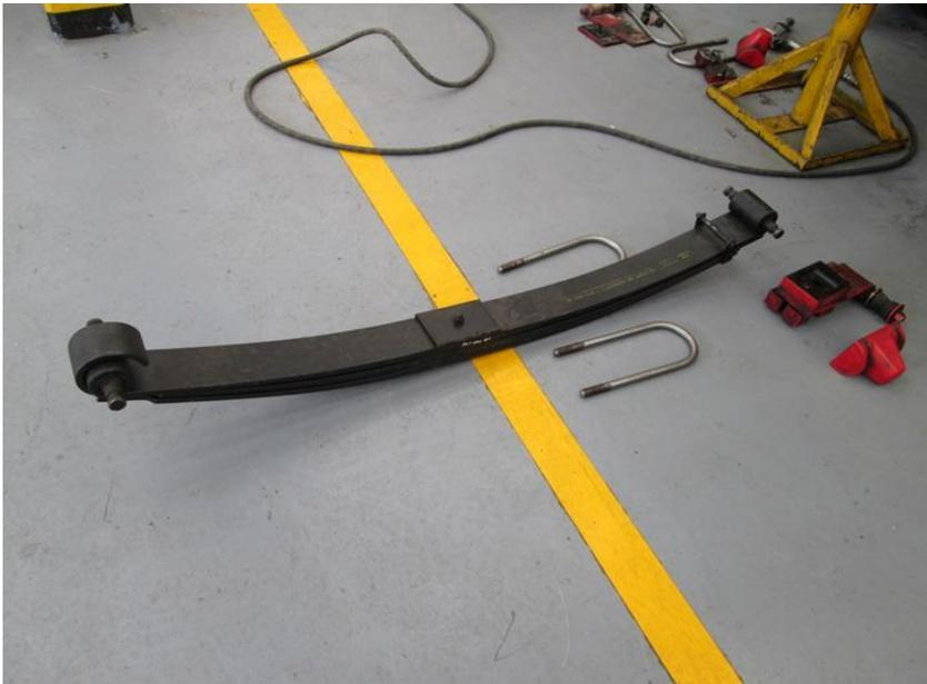
**FIGURA 34. UNIÓN BALLESTA DELANTERA. DE LOS AUTORES**
