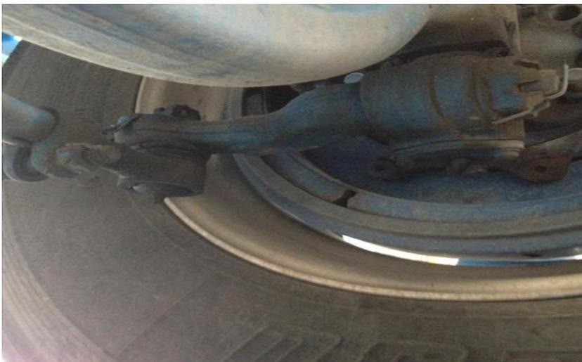
**FIGURA 36. UNIÓN MUÑÓN DE DIRECCION INFERIOR. DE LOS AUTORES**
