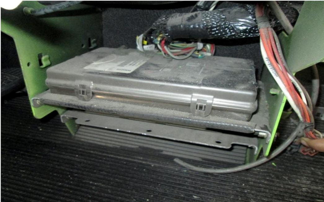
**FIGURA 46. UNIÓN DE LA UNIDAD DE CONTROL MOTOR (ECU). DE LOS AUTORES**
