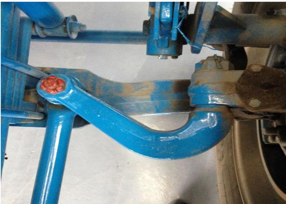
**FIGURA 35. UNIÓN MUÑÓN DE DIRECCION SUPERIOR. DE LOS AUTORES**
