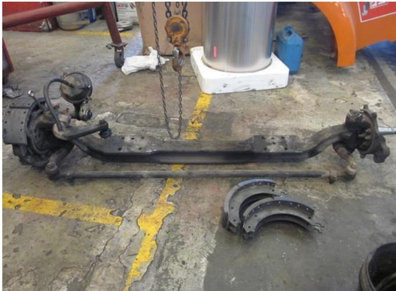
**FIGURA 37. UNIÓN EJE DE SUSPENSION DELANTERA. DE LOS AUTORES**
