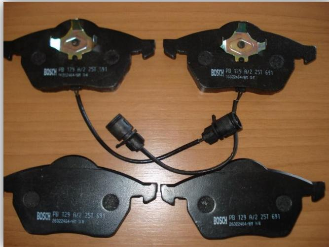
*Ilustración 15. Pastillas de frenos con sensores/ Google*
