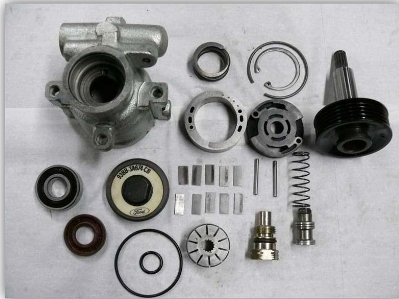
*Ilustración 6. Partes bomba de dirección hidráulica/ Google*
