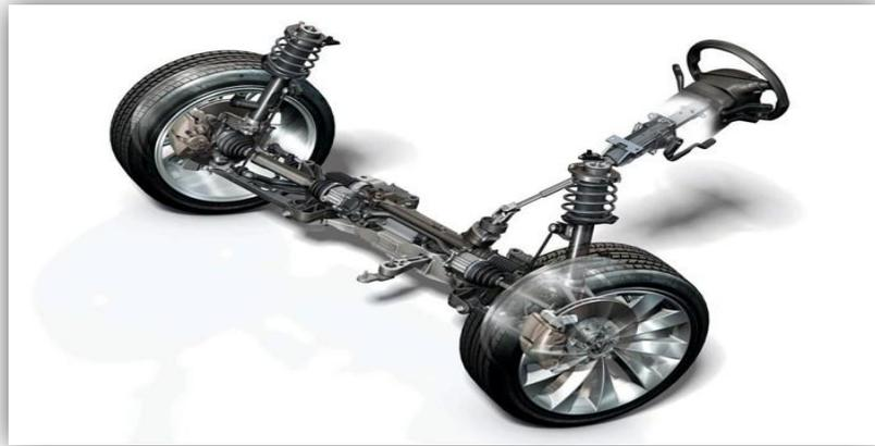
*Ilustración 5 Componentes sistema de dirección/ Google*
