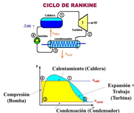
Figura 1 (principio de funcionamiento Ciclo Rankine)
