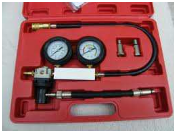
Fig. 1-16 Elementos Para Medición De Fugas.
