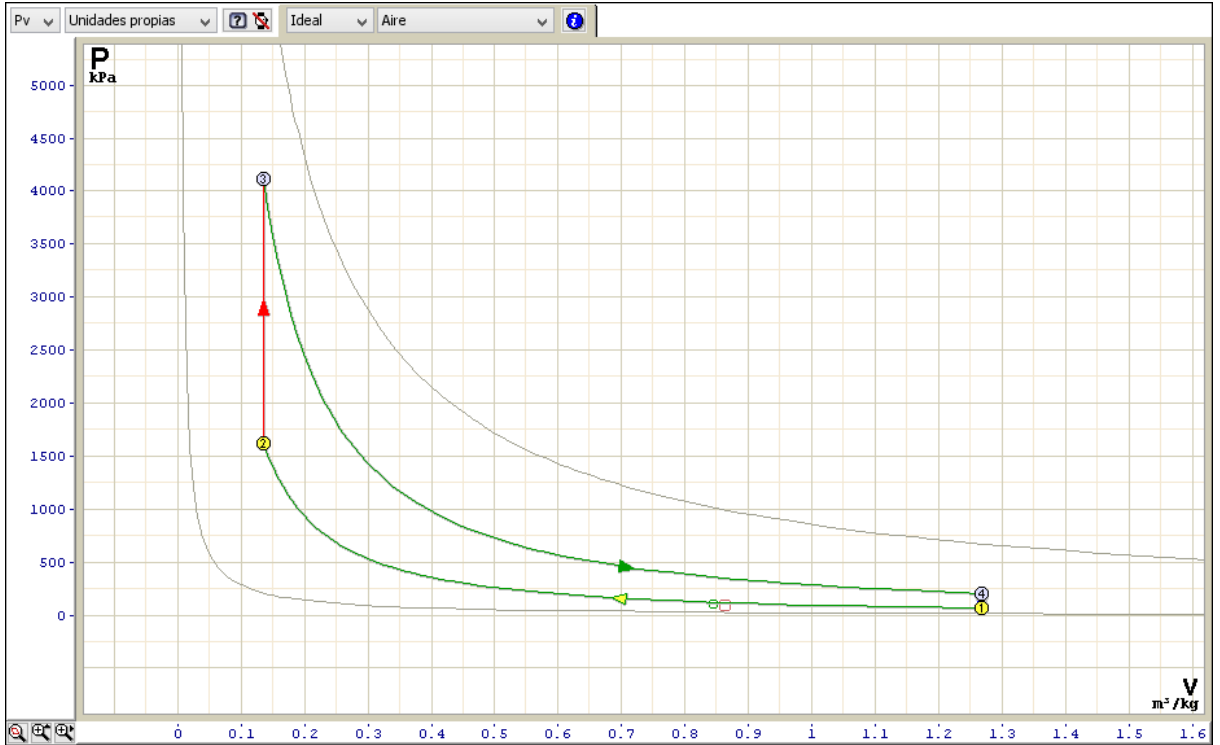
Fig. 9-15 Diagrama Teórico Del Motor Estándar.
