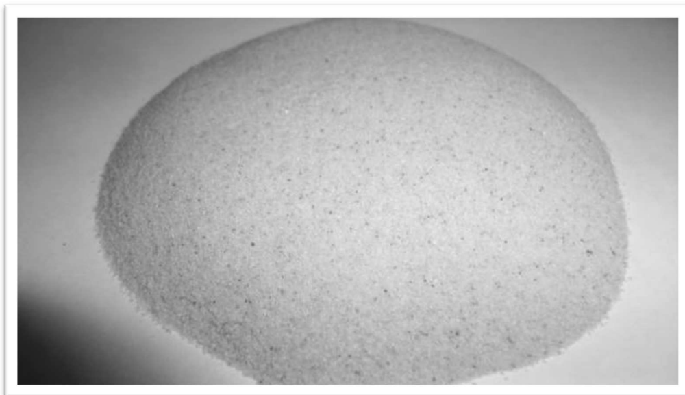
Figura 12 Abrasivo, arena sílice de granulometría AFS 50/70.
