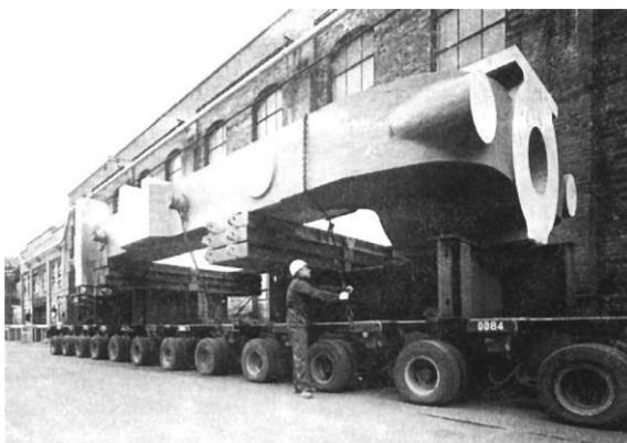
*Figura 3. Fundición en Acero (Peso: 280 toneladas).*
