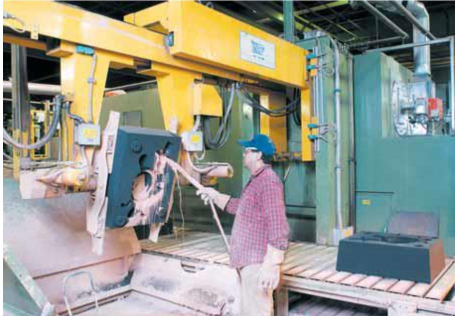
*Figura 17. Proceso de adición química sobre el molde en arena.*
