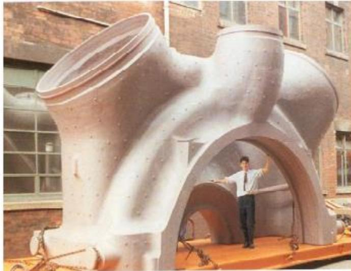
**Figura 2. Fundición en acero para planta de energía nuclear.**
