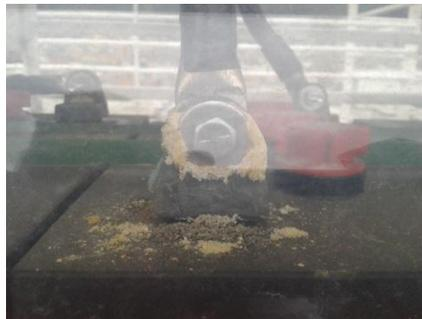
*Ilustración 9 Bornes de las baterías sulfatados*
