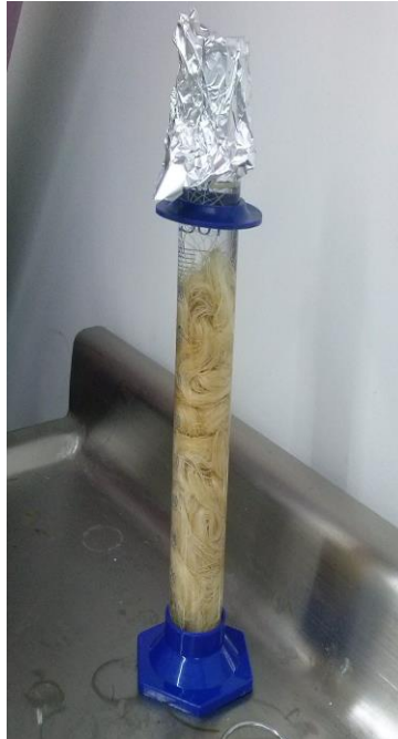
Figura 11: Fibra de fique pretratada sometida a tratamiento con propóxido de titanio
