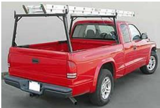
Figura 9: Transporte adecuado de escaleras en vehículos
