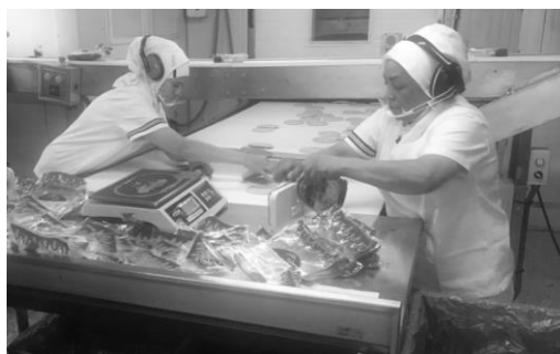
Figura 14. Operaria recogiendo arepa de banda transportadora junto a operaria empacando arepa Fuente. Autores
