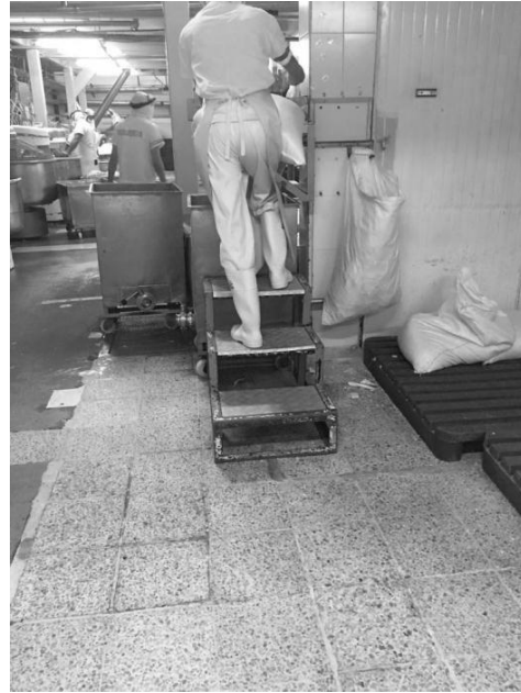
Figura 3. Operario subiendo bulto a Trampa magnética Fuente: Autores
