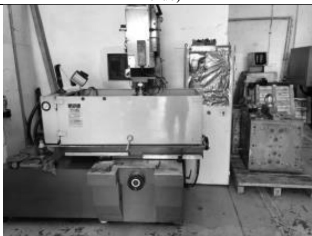
Erosionadora (Definición de detalles del molde)
