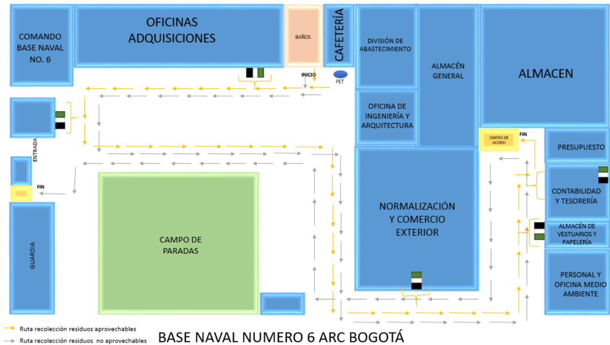
Imagen 11. Rutas de recolección y puntos de generación de residuos en el Puesto de Mando de la Base Naval No.6 ARC “Bogotá”
